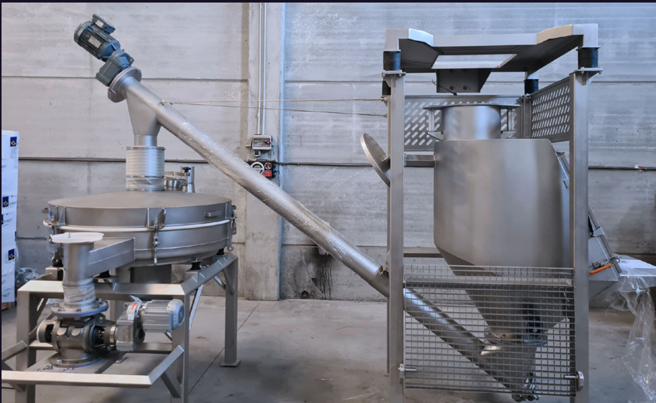
Estación mixta BB's y sacos con cribado y envío neumático.
