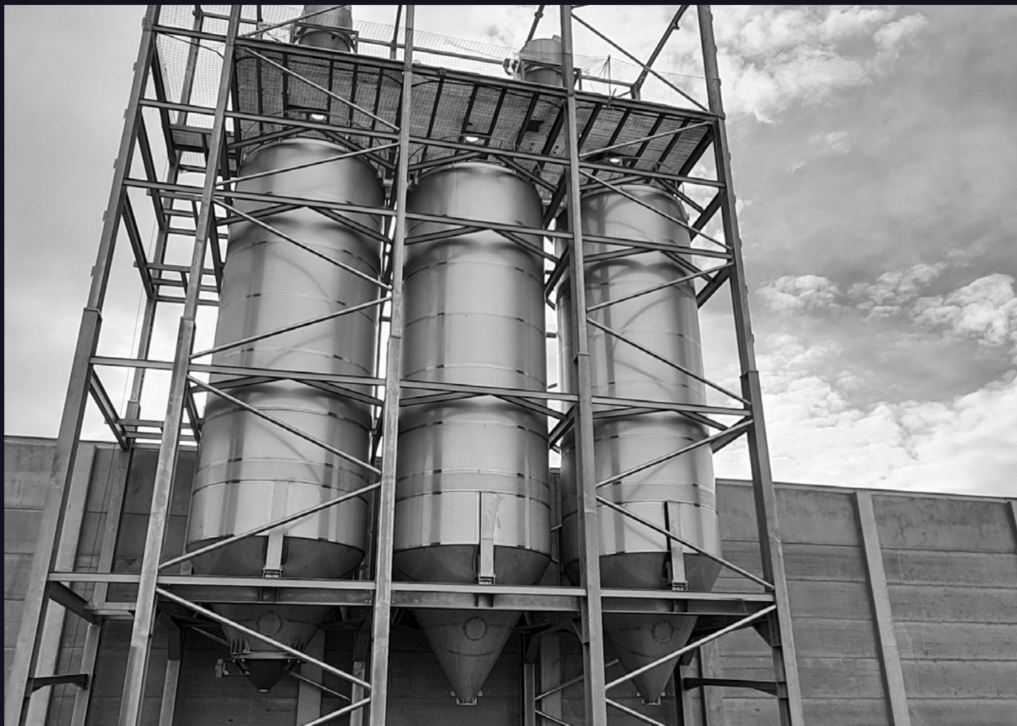
Dos tolvas filtro que alimentan por gravedad a 3 silos mediante sinfines.
