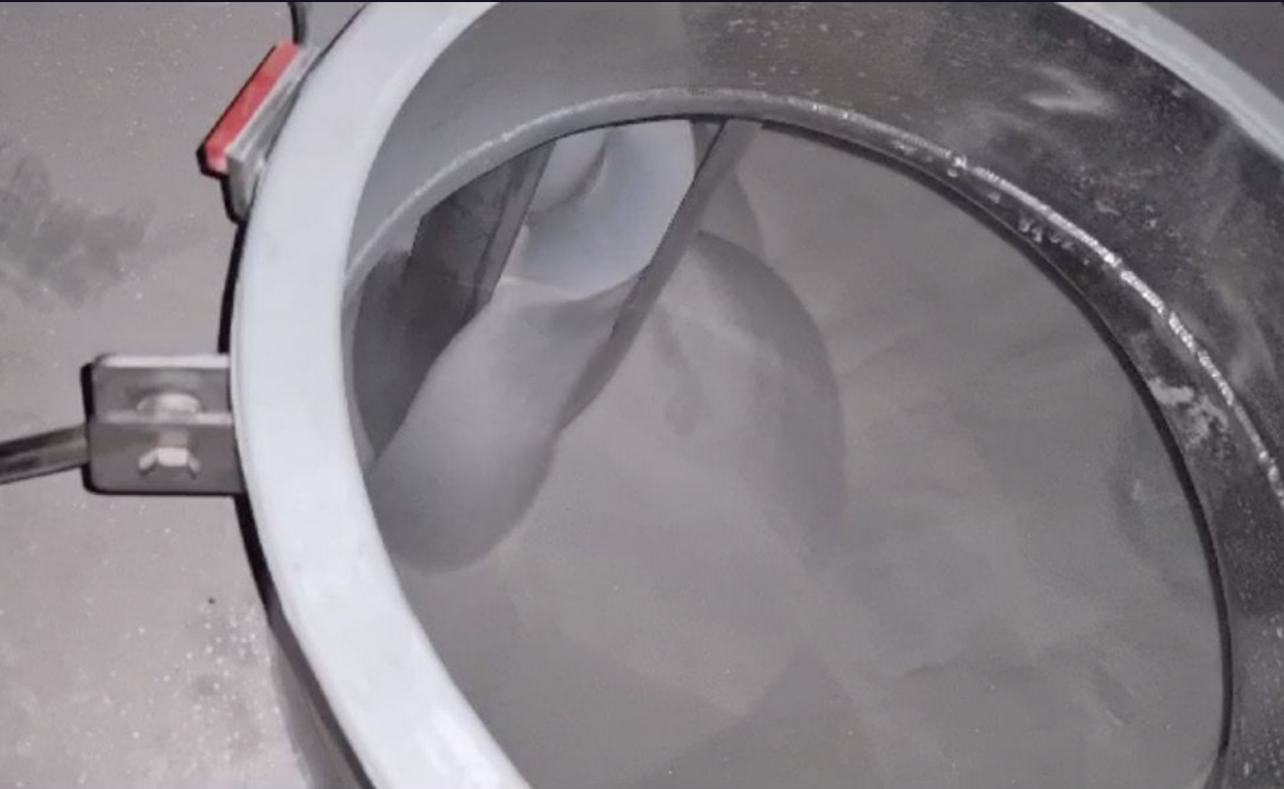
Imagen interior de la tolva con homogenización mediante sinfín.
