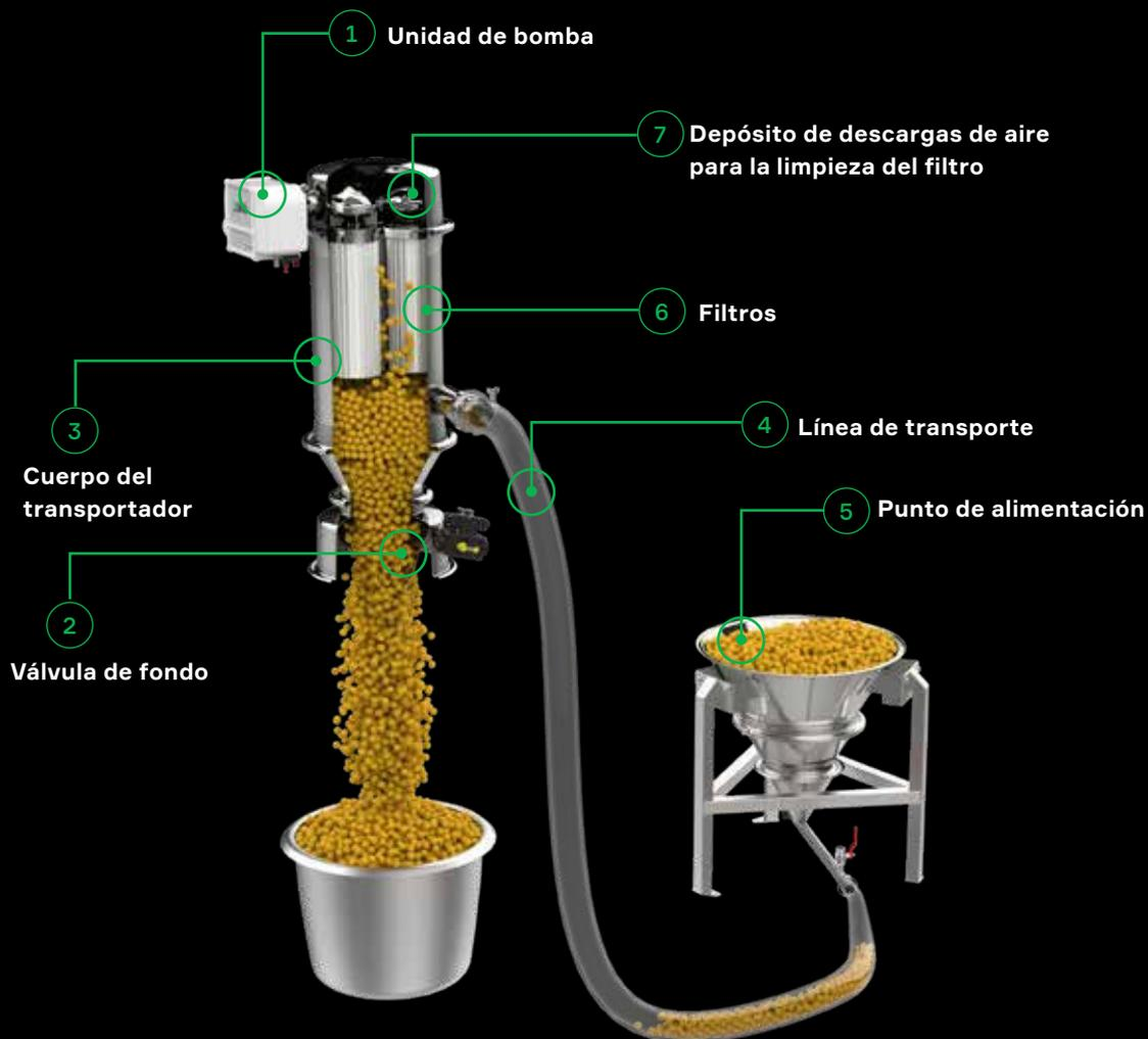
Los transportadores por vacío de Piab transportan sólidos a granel, gránulos y piezas pequeñas usando una presión negativa desde un Punto de alimentación (5) hasta un elemento receptor del equipo.
