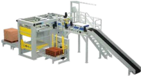
Paletizadora automática de carga por alto mediante arrastre lateral y pataforma móvil de formación de palets
