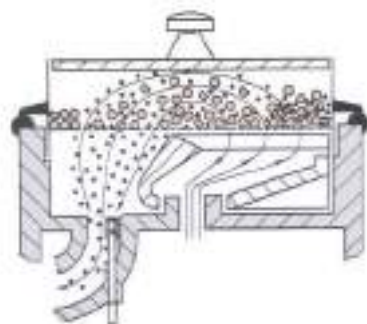
Corriente de aire que arrastra las partículas haciéndolas pasar a través del tamiz.
