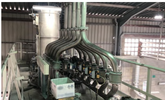
Báscula de succión con selección múltiple de componentes
