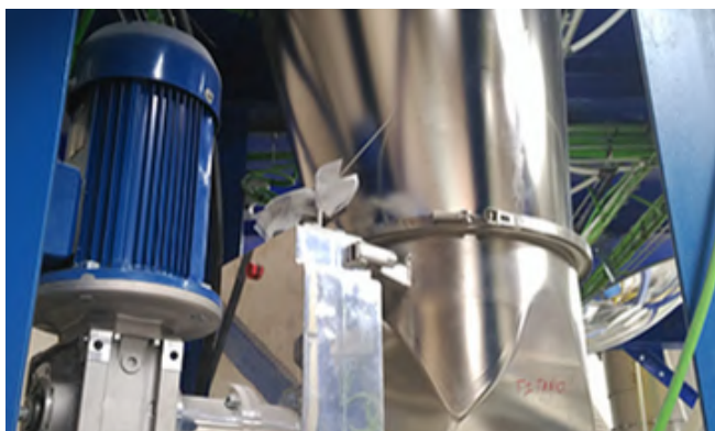
Dosificador de monotornillo
