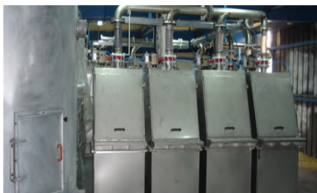
Tolvas para carga manual con aspiración centralizada
