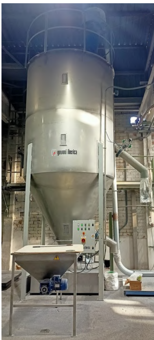
Mezclador vertical de acero inoxidable
