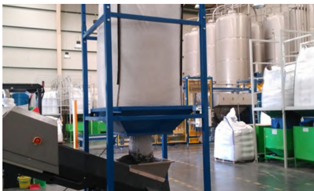
Estación Big-Bag para productos granulados
