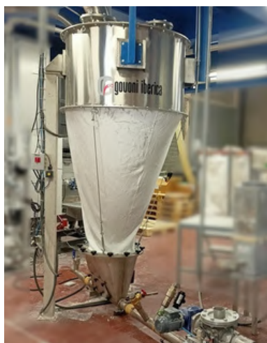
Tolvas para carga manual con aspiración centralizada
