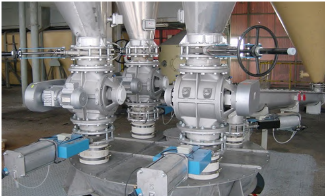
Válvulas rotativas flujo cruzado
