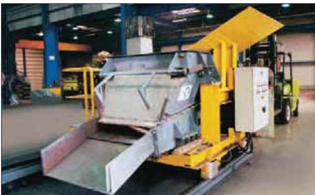
Figura 15: Carro para la alimentación del horno
