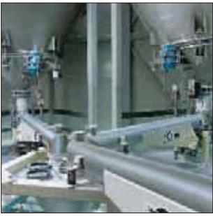
Figura 1: Transportador tubular para alimentación a una tolva de pesado
