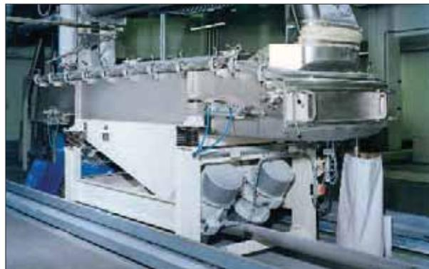
Figura 9: Máquina SR 36/10 de cribado en una fábrica de proceso de alimentos
