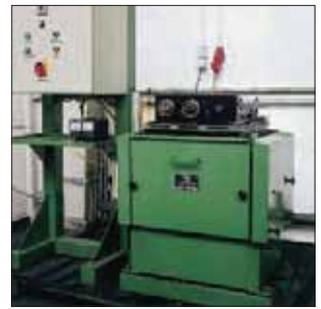
Figura 20: Vibración de mesa para las pruebas de resistencia mecánica
