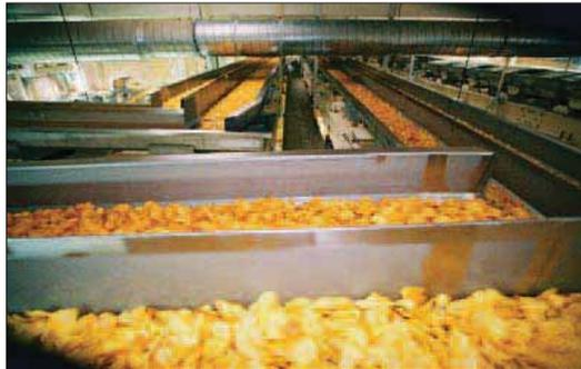
Figura 3: Vista parcial de una instalación de transporte vibrante con una longitud de 120 metros, utilizado para transportar las patatas fritas a una velocidad de 60 m<sup>3</sup> / h.
