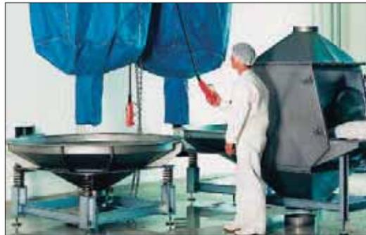
Figura 17: Equipo vibratorio para la descarga de big-bags y bolsas
