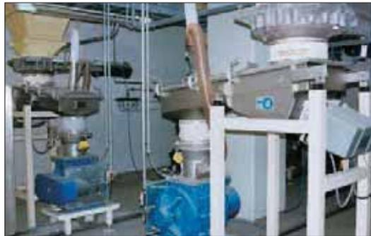
Figura 13: Alimentador vibrante bajo tolva para descargar y dosificar
