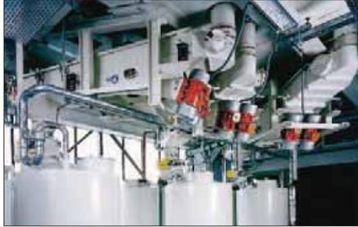
Figura 2: Dosificación con alimentadores en una planta química
