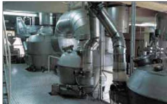
Figura 27: secador de lecho fluido vibrante por lotes para tostar picado de almendras
