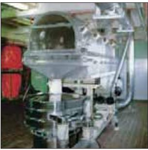
Figura 21: VF 40/10 Secador de lecho fluido vibrante en una fábrica de proceso de alimentos
