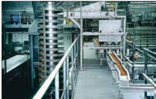
Figura 4: Elevador helicoidal y transportadores en una fábrica de procesamiento de alimentos.
