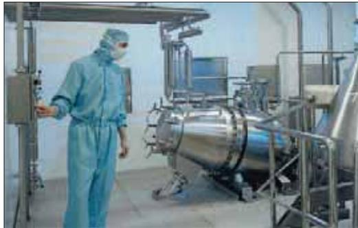
Figura 8: Criba adecuada a zona CIP y zona esterilizada (foto Schering AG)
