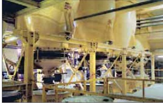
Figura 12: SX fondos vibrados en una fábrica de detergente
