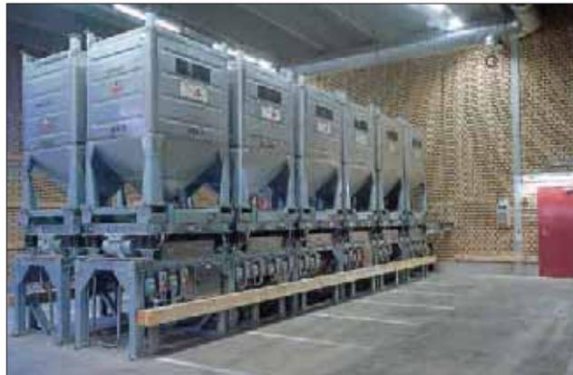
Figura 18: marcos vibratorios para la descarga de contenedores
