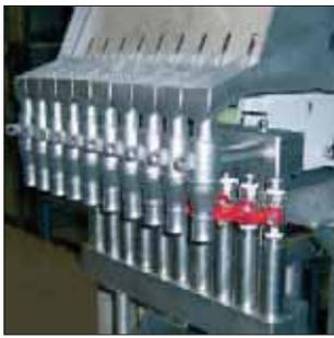
Figura 11: transportadores ER procesamiento por lotes de diseño especial para la dosificación de granulos de catalizador.
