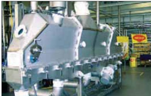
Figura 23: Vibración de lecho fluido secador de VF 40/3,5 en un centro de desarrollo
