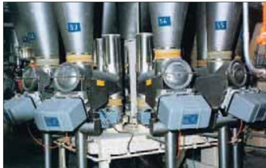
Figura 14: Picos vibrados descargados con alimentadores electromagnéticos
