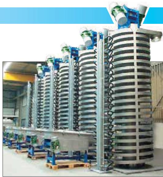
Figura 26: elevador en espiral de enfriamiento 1400 mm de diámetro de ancho, con cribas para escurrir y refrigerar 3000 kg / h gránulos plásticos cada uno
