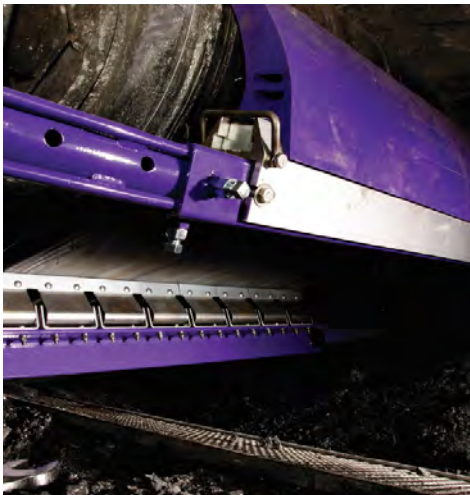
Rascador primario de poliuretano y secundario de tungsteno
