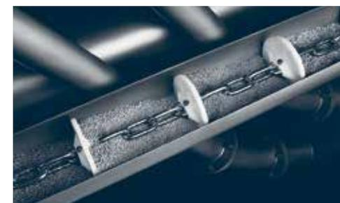
Los transportadores tubulares de arrastre son diseñados para mover todo tipo de materiales de forma segura, higiénica y eficiente. **El método lento de transporte es extremadamente eficiente en el consumo energético y lo suficientemente suave para soportar una gran cantidad de productos diferentes.**
