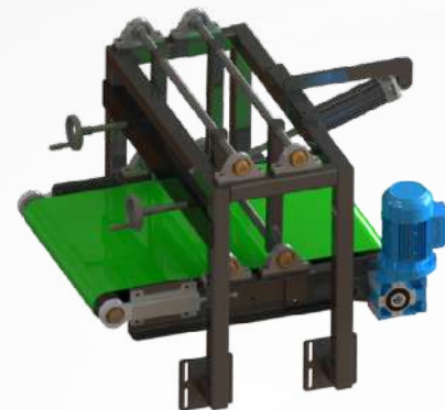
Sistemas de prensa para dar uniformidad a los sacos
