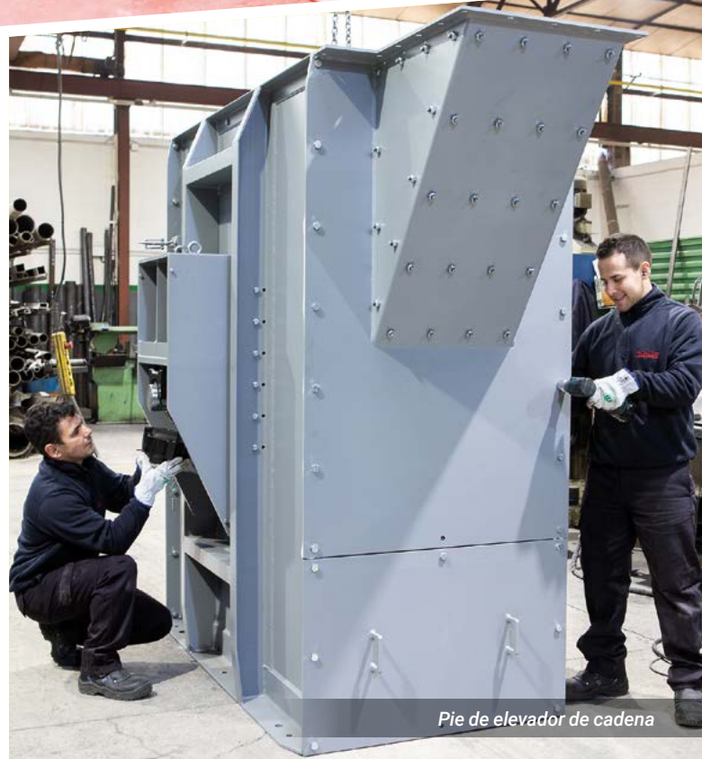
Instalación de un elevador de cadena
