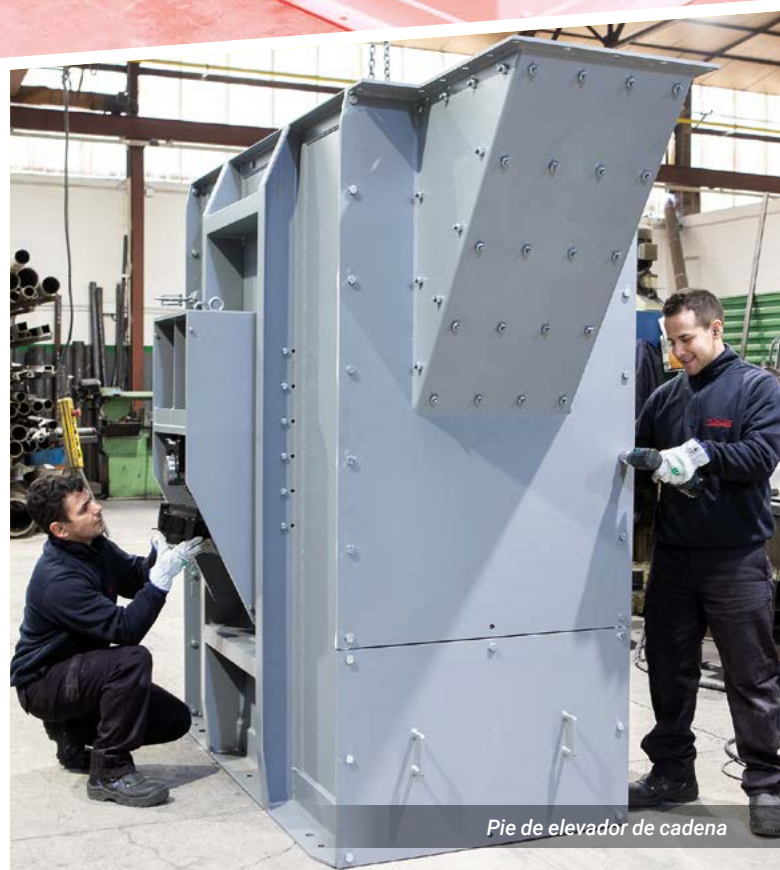
Instalación de un elevador de cadena
