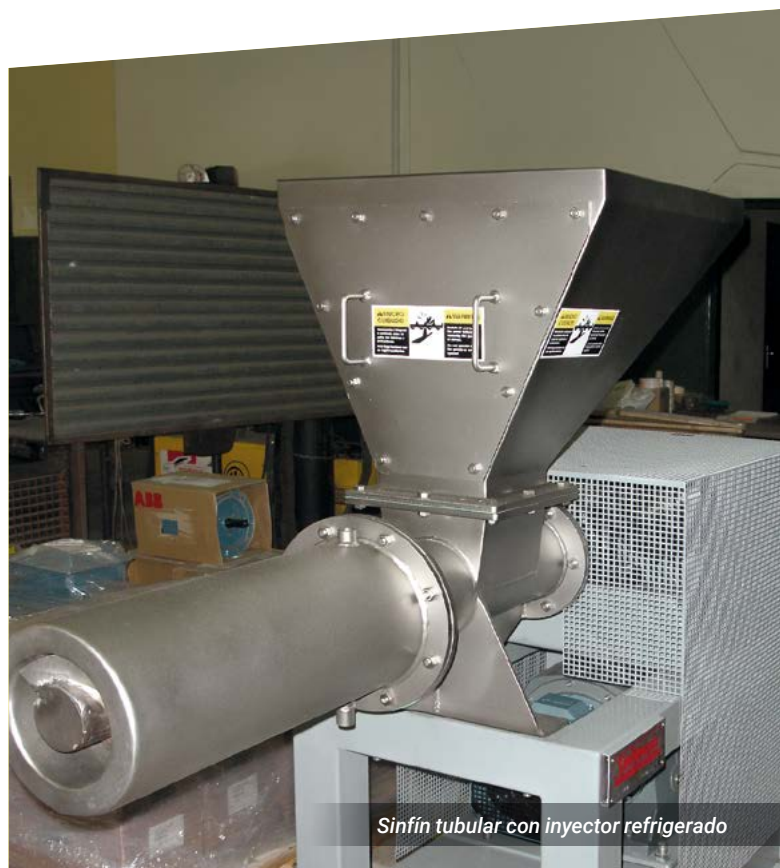
Fabricación de un sinfín tubular
