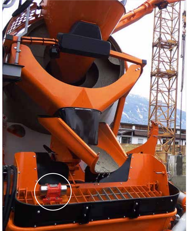
MVE-DC (vibrador eléctrico) - Bomba de hormigón
