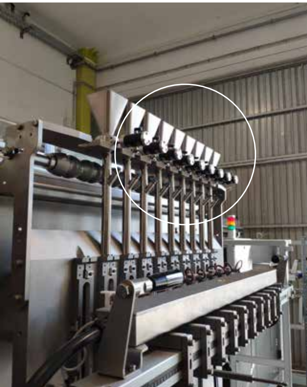
K (vibrador neumático lineal) - Vaciado de tolva
