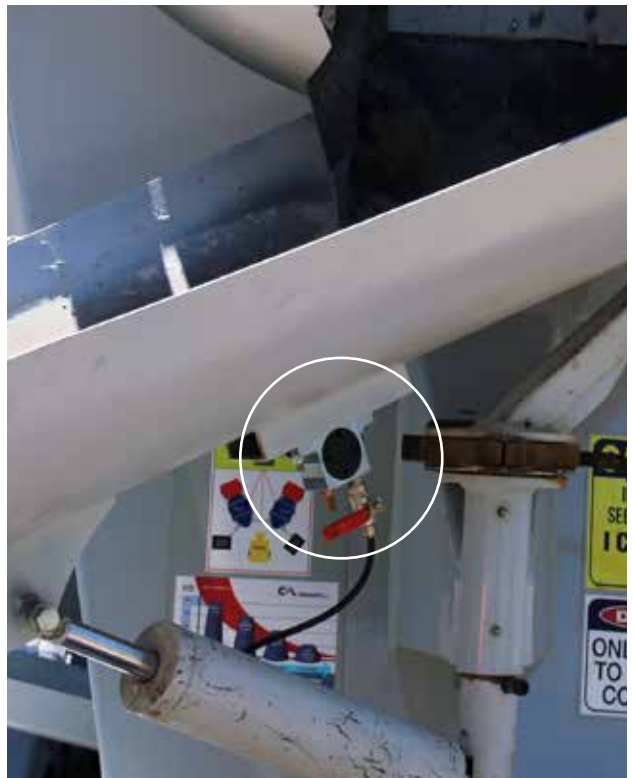
OT (vibrador neumático rotativo) - Canaleta de hormigonera
