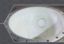
Placas protección tornillo sinfín de **Carburo de tungsteno** de una decantadora centrífuga
