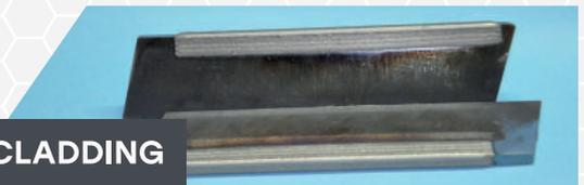
Es una técnica para agregar una capa de **Carburo de Tungsteno y Níquel (WC - Ni)** sobre una superficie metálica. El proceso de revestimiento láser permite mejorar las propiedades de la superficie de una pieza, incluida una mejor resistencia al desgaste, además de permitir la reparación de superficies dañadas o desgastadas. Crear esta unión mecánica entre el material base y la capa de **WC - Ni** es uno de los procesos de soldadura más precisos disponibles.
